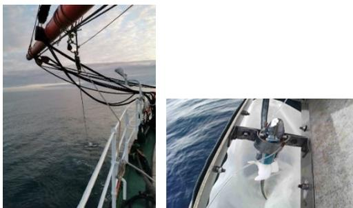
Рис. 1. Выполнение нейстонной станции сетью «Мантa» (слева) и расположение цифрового счётчика протока воды в рамке перед её уловистой частью (справа)
