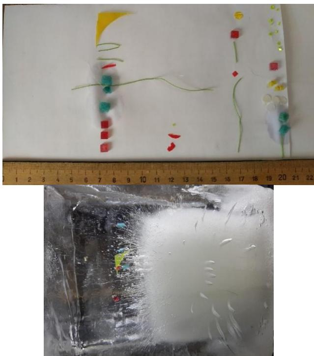
Рис. 1. Распределение экспериментальных частиц пластика в керне пресной воды
