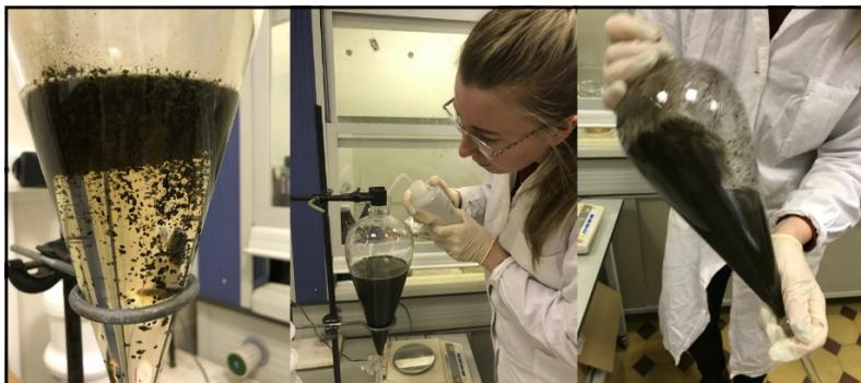
Рис. 1. Процесс обработки донных отложений с помощью делительной воронки
