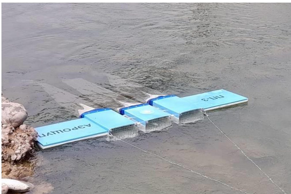
Рис. 1 – Устройство для отбора проб воды ПП-3 для количественного анализа микропластика на водотоках
